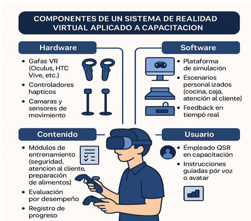
Figura 2.6 Componentes de un sistema de realidad virtual aplicado a procesos de capacitación en empresas de comida rápida (QSR).
