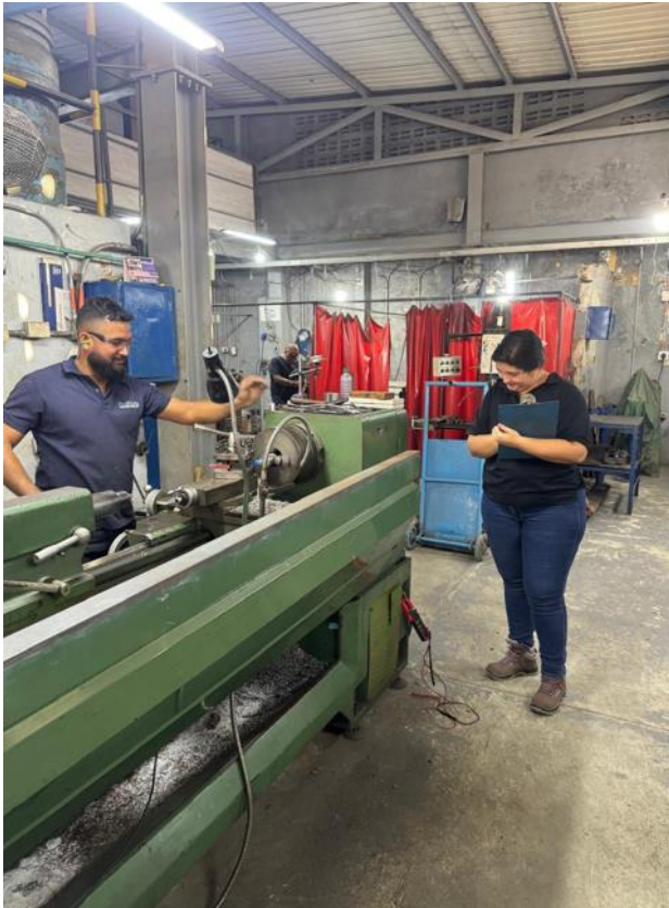
Figura 21. Medición de variables operaciones asociadas al consumo energético proceso de torneado.
