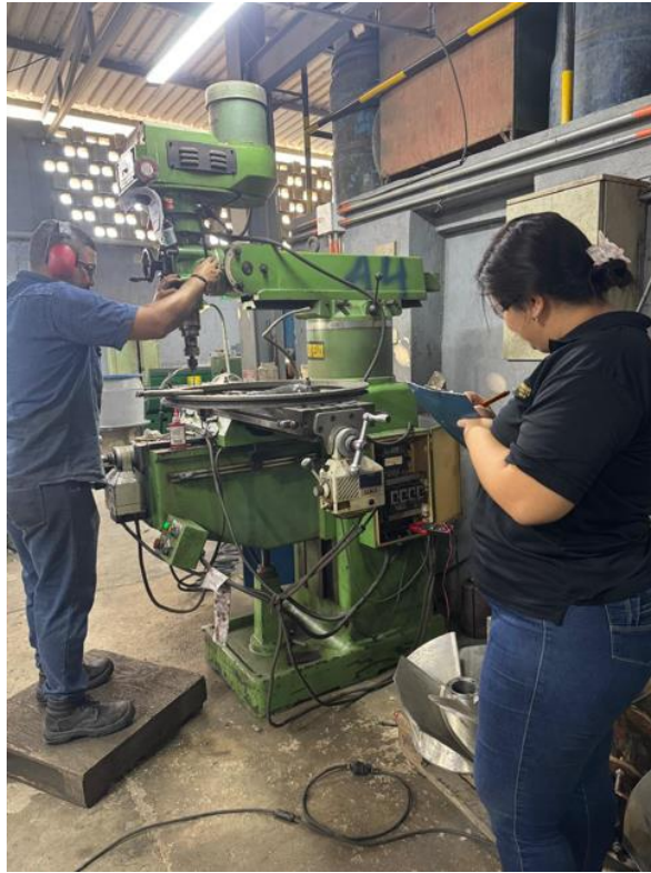
Figura 20. Medición de variables operaciones asociadas al consumo energético proceso de fresado.
